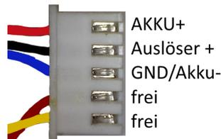
Abbildung 9: Belegung der HL Blitzeinheit
