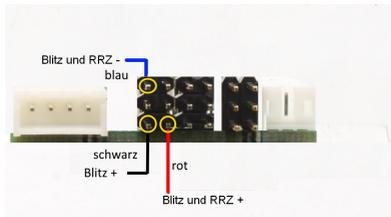
Abbildung 10: Anschluss der HL und Tamiya Blitzeinheit am Modul
