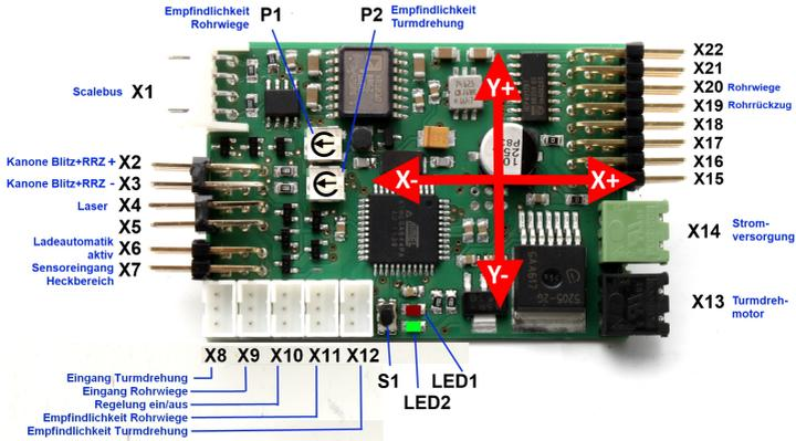
Abbildung 1: Übersicht der Steckverbinder
