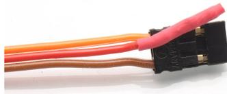
*Abbildung 4: entfernte und isolierte + Zuleitung im Servostecker*
