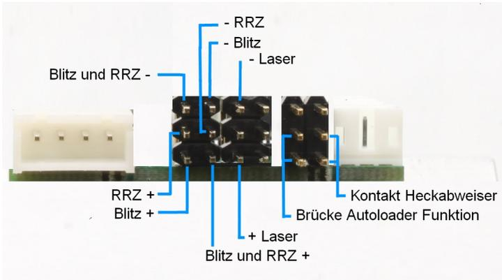
Abbildung 2: Belegung der Steckverbinder für Eingänge und Schaltausgänge
