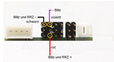
Abbildung 11: Anschluss für Blitzeinheiten mit negativem Auslöseimpuls
