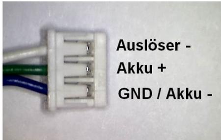
Abbildung 12: Belegung des Tamiya Rohrrückzugmotors
