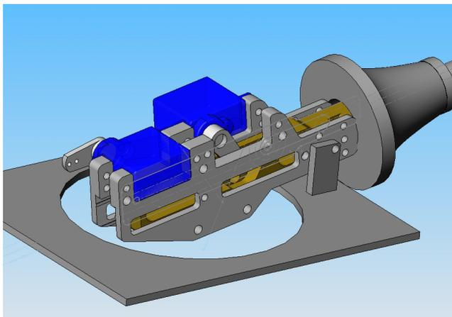
Abbildung 7: Beispiel einer Rohranhebe und Rückzugseinheit mit Servos
